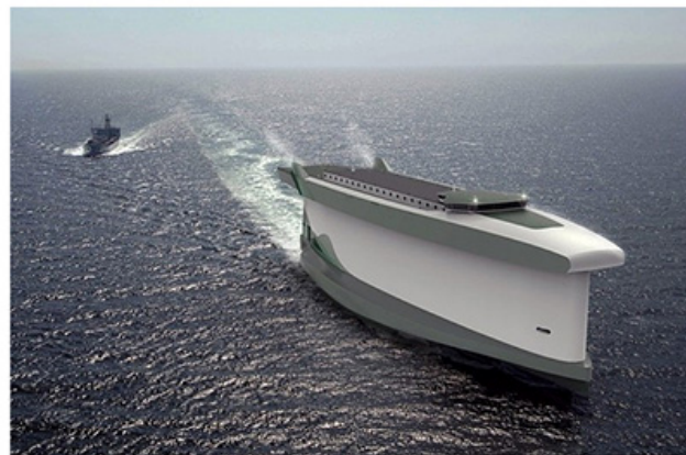
De romp van Vindskip werkt als een zeil, waardoor het schip efficiënter vaart. Vindskip
