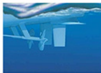
Een soort spoiler voor schepen: Hull Vane. Van Oossanen Naval Architects
