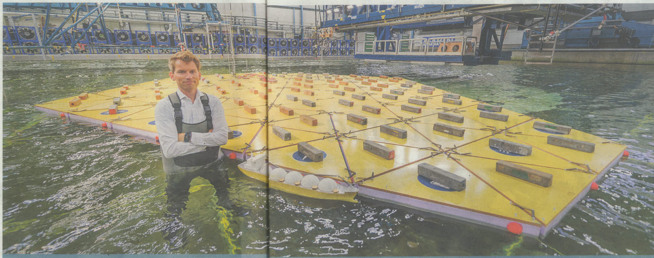
Olaf Waals is bedenker van het drijvende eiland. Het schaalmodel wordt deze week tijdens tests onderworpen aan wind, stroming en golven in het grote Outdoors Bassin van Marin in Wageningen.
